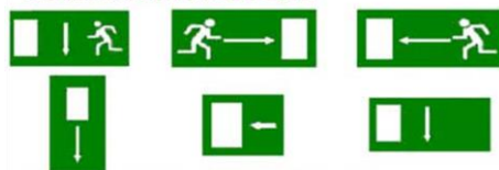
Cartelli indicanti il percorso/uscita di emergenza
